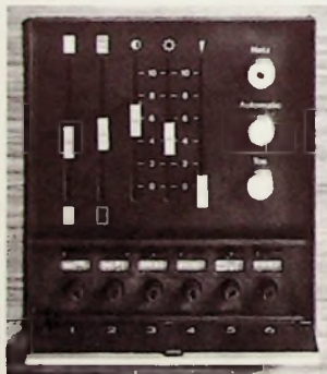
Bild 3. Unteres Bedienungsfeld mit beifreier Klappe zugänglichen Potentiometerdrehknöpfen für die Sendervorwahl
