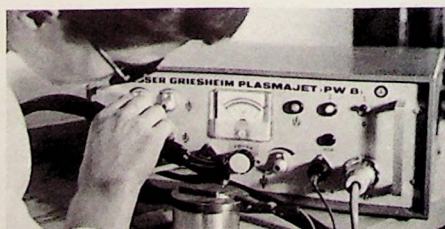
Mikroplasma-Schweißanlage „PW 8“ (Messer Griesheim)
